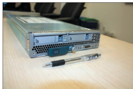
Блейд-сервер половинной ширины позволяет разместить два жестких диска
