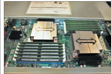
Каждый блейд-сервер с процессорами Intel Xeon 5500 series поддерживает до 96 Гб ОЗУ DDR3
